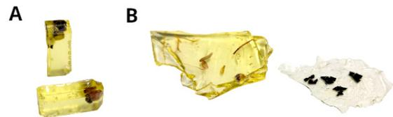
Figura 6: Muestras incluidas en resina polimerizada. A: Bloques de resina. B: Láminas de resina. La de la derecha es suficientemente fina como para estudiarse con el microscopio óptico previamente a su procesamiento para microscopía electrónica.
